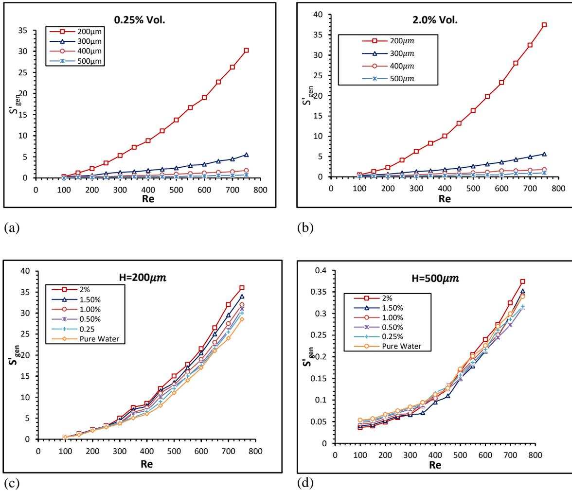
**Fig. 8:**  $S'_{gen}$  vs.  $Re$  for (a).  $\phi=0.25\%$  (b).  $\phi=2.0\%$  (c).  $H= 200\mu m$  (d).  $H= 500\mu m$
