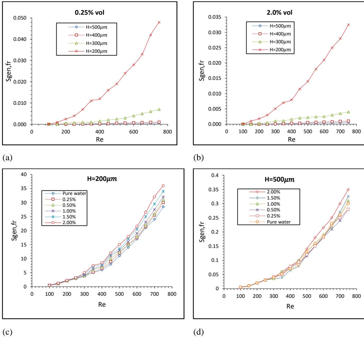
**Fig. 7:**  $\dot{S}_{gen,fr}$  vs.  $Re$  for (a).  $\phi=0.25\%$  (b).  $\phi=2.0\%$  (c).  $H=200\mu m$  (d).  $H=500\mu m$
