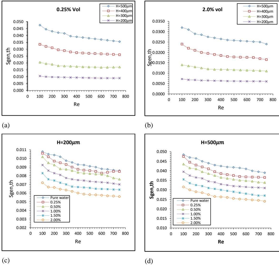
**Fig. 6:**  $\dot{S}'_{gen,th}$  vs.  $Re$  for (a).  $\phi=0.25\%$  (b).  $\phi=2.0\%$  (c).  $H=200\mu m$  (d).  $H=500\mu m$
